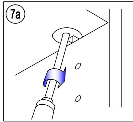
После установки полок, стяжки зафиксировать поворотом эксцентрика внутри стяжки при помощи крестовой отвертки
